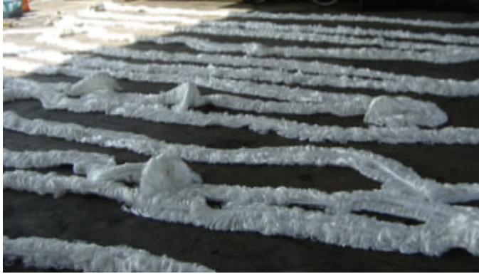
写真3 捕集機能と係留機能を一体化させたモール状捕集材
